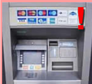
Bankomat z założonym nad wyświetlaczem "daszkiem", pod którym ukryta jest kamera skierowana na klawiaturę
